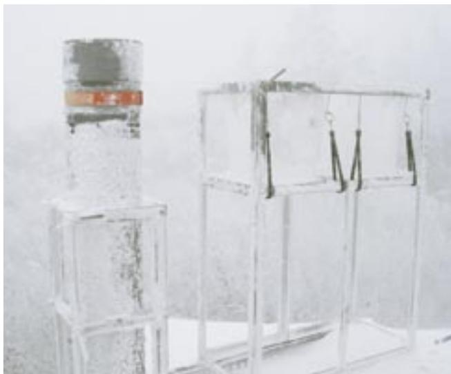
図4 田茂范岳山頂付近に設置した雨や雪の採取装置
