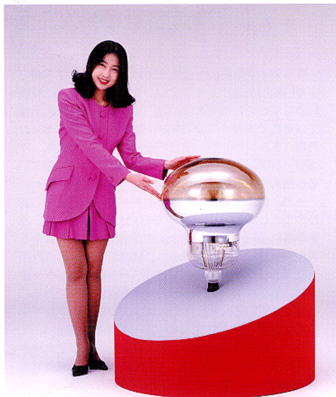
ニュートリノ検出のための光電子増倍管 （直径20インチ=約50cm）：約11000個設置されている。 浜松ホトニクスより提供
