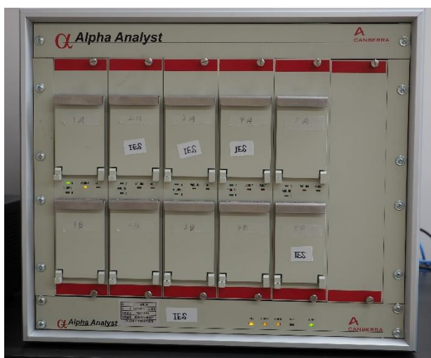
図1 \alpha 線スペクトル分析装置
