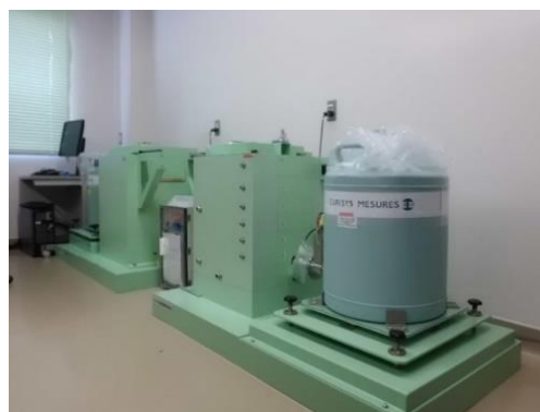
図11 Ge 半導体検出器付多重波高分析装置
