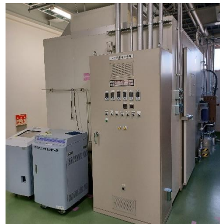
図 24 鉢植えナガイモの ^{13}\text{CO}_2 ばく露に用いるチャンパー
