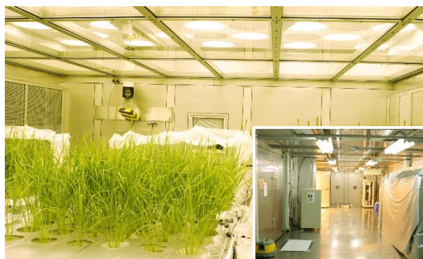
図2 CEEF_閉鎖系植物実験施設_人工光型植物栽培室（床面積43m 2 、容積146m 3 、栽培面積30m 2 、3室）及び植物栽培モジュール1F作業室（右下）
