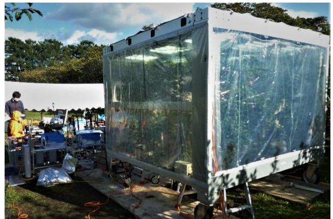
図 23 野外（果樹園）におけるリンゴ成木 ^{13}\text{CO}_2 ばく露の様子
