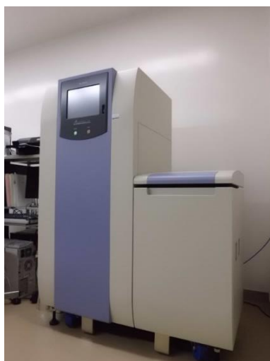
図9 液体シンチレーションカウンター (日立アロカメディカル LSC-LB7R48-1)
