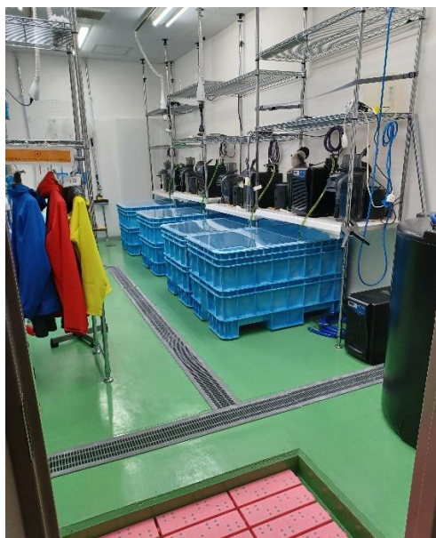
図 25 ヒラメ等における放射性ヨウ素の長期的移行調査のため RI 域外使用区域として設定し、防水床、排水溝等を敷設した実験室
