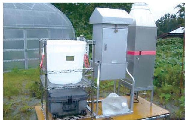
図2 大気中粒子状物質を採取するためのハイボリウムエアサンプラー (中央)
