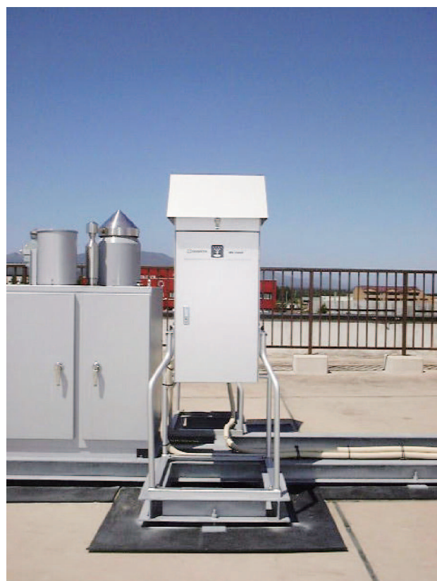
写真 ハイボリュームエアースAMPLER 最大毎分 1000 リットルの空気を吸引し、空気中に含まれる大気浮遊じんをフィルター上に捕集することができます。
