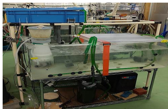
図2 循環水槽を用いたホタテガイ（稚貝）の重水ばく露実験の様子
