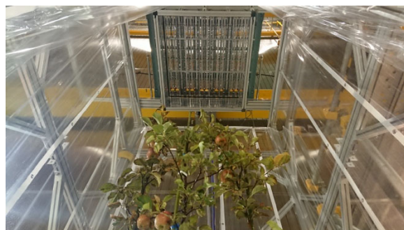
図1 樹皮表面に粒子状セシウムを、又は果実表面に粒子状ヨウ素を負荷したリンゴ樹を雨にばく露している様子
