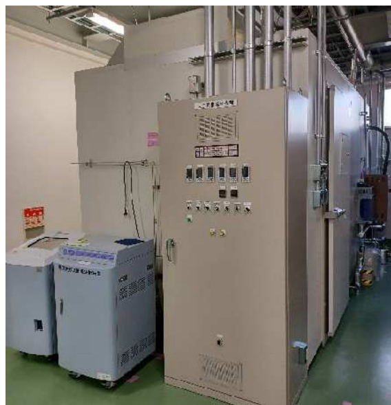
写真1 鉢植えナガイモ用 ^{13}\text{CO}_2 ばく露チャンバー
