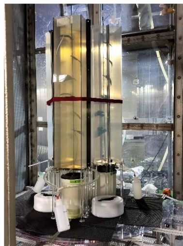
写真1 地上部表面に粒子状セシウムを負荷したナガイモを雨にばく露している様子
