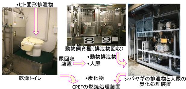
図 10 閉鎖居住実験で用いた CAHEF の廃棄物処理システム
