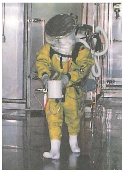
図 17 開発した閉鎖型作業服
