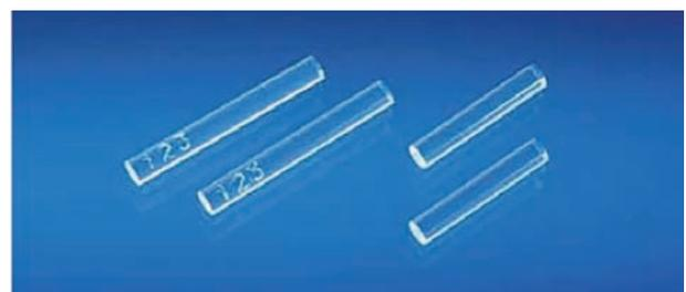
図 2 ガラス線量計素子（直径 1.5 mm、測定では左の長さ 12mm の素子を使用）。照射後、読取機で紫外線を当て蛍光量を読み取る。
