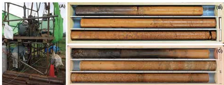
図 1 ボーリング法による土壤試料の採取。(A) 採取作業、(B) 牧草地から採取した土壤試料、(C) 森林から採取した土壤試料(土壤試料の採取深度は B、C それぞれで左上が深度 0m、右下が 3m)
